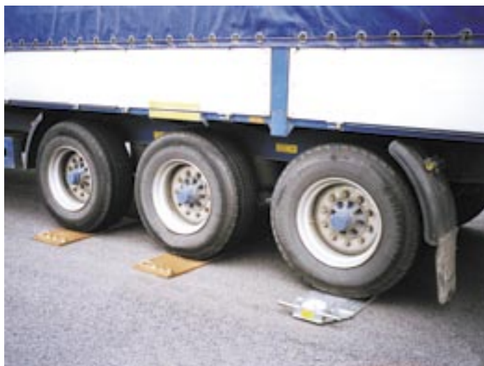
Contrôle de pesage statique avec pesons mobiles Haenni - LROP
