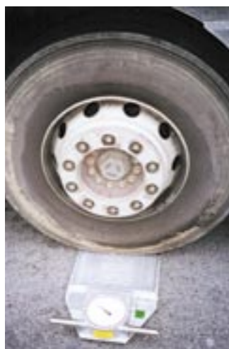
Pesage d'un essieu de véhicule avec peson mobile Haenni - LROP
