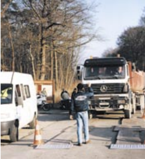
Contrôle de pesage sur une aire non aménagée - LROP
