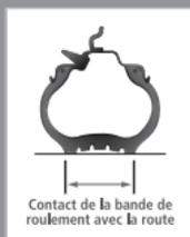
Entraîne l'écrasement anormal du pneu, provoquant l'échauffement et causant l'usure irrégulière.
