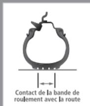
Entraîne un roulement dur, rendant le pneu plus vulnérable aux chocs. Cause également l'usure irrégulière.
