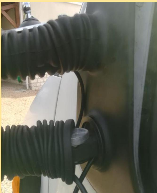
Puis récupération du coax côté intérieur de la platine du rétro
