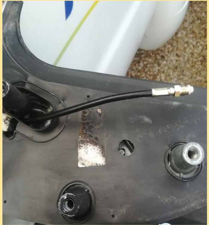
Récupération du coax à l'intérieur de la portière (après avoir percé un trou à côté de celui existant pour le maintien de la platine)
