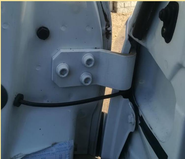
Récupération et passage du coax dans le compartiment moteur (après perçage d'un trou et pose d'un passe câble)
