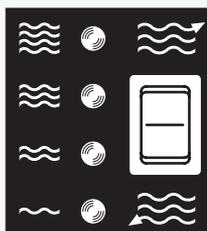
Quatre voyants de contrôle affichent le niveau du réservoir d'eau sélectionné.
