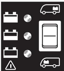
Trois voyants de contrôle affichent l'état de charge de la batterie dépendant de la tension de batterie sur 3 niveaux. Dès que le commutateur est actionné, le voyant de contrôle s'allume pour la plage de tension correspondante.
