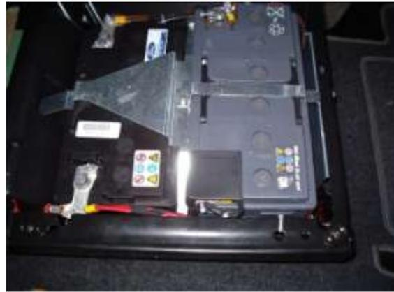
La batterie cellule (grise) gel [L.353mm/l.175mm/H.190mm] EXIDE ES 900, devant la batterie du porteur (noire) à électrolyte liquide [L.310mm/l.175mm/H.175mm] FORD Silver Calcium.
