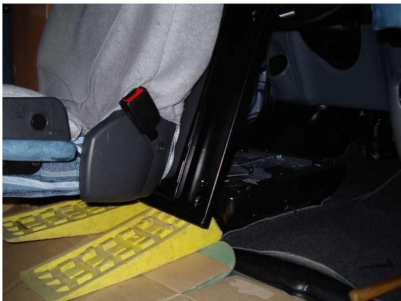
Deux batteries de 80 Ah se trouvent dans ce coffre. Hauteur maximum = 190mm.
