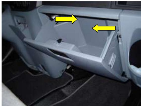
2. Dégrafer les clips de maintien du boîtier de relais standard pour accéder au boîtier de raccordement d'habitacle situé derrière.
