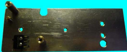
Plaque arrière d'assemblage et de support guillotine Fixation par les vis des bobines.
