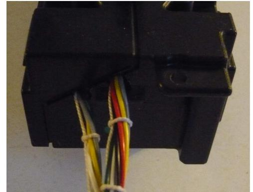
Ménager deux passages de fils dans la partie basse de la protection du CI d'origine (photo ci-contre).
