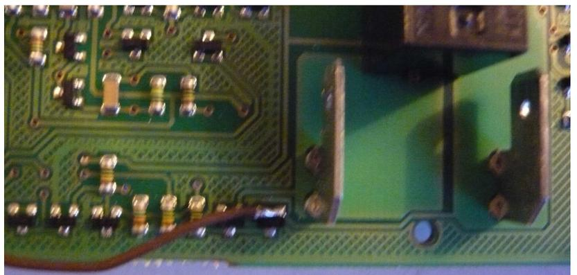
Une connexion 230 Volts existe sur le CI d'origine mais il est préférable d'en ramener une depuis l'arrière du frigo, la récupération sur le CI origine n'étant pas prudente.
