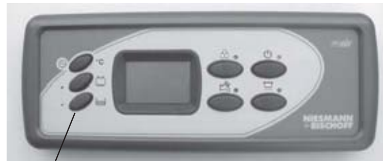
Touche Pos.4, vérification du niveau dans les réservoirs d'eau et des aux usées
