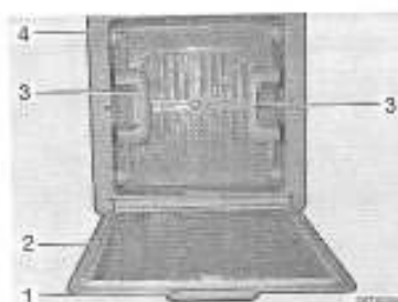
Fig. 55 Lanterneau à poussoirs (variante 2)
