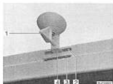
Fig. 56 Lanterneau basculant, dispositif de verrouillage
