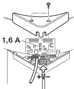
Il fusibile a filo sottile deve essere sostituito solamente con un fusibile simile, 1,6 A (ritardato), EN 60127-2-3.
