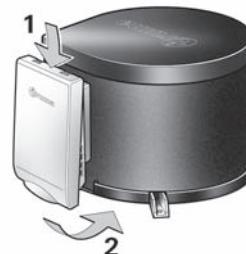
**!** Colocar la tapa de la chimenea, cada vez antes de iniciar un viaje, estando el calentador desconectado. Prestar atención a que quede perfectamente alojada y encajada (peligro de accidente). Las tapas de chimenea defectuosas no deben seguir utilizándose.
