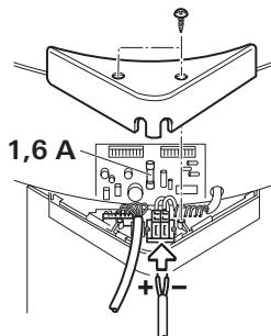
Die Feinsicherung darf nur gegen eine baugleiche Sicherung ausgetauscht werden. 1,6 A (träge), EN 60127-2-3.
