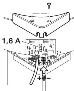
Le fusible ne doit être remplacé que par un fusible de construction identique, 1,6 A (inerte), EN 60127-2-3.
