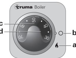
a = Drehschalter „Ein (Gasbetrieb)“
