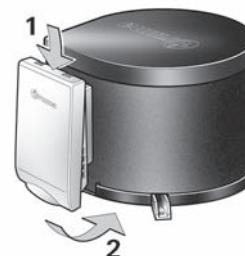
**⚠️** Avant chaque départ, installer le cache ventouse lorsque le chauffe-eau est éteint. Veiller à ce qu'il tienne solidement et soit enclenché (risque d'accident). Il est interdit d'utiliser des cache-ventouses défectueux.
