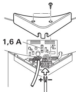
Finsikringen må kun udskiftes med en sikring, der har en tilsvarende konstruktion. 1,6 (træg), EN 60127-2-3.
