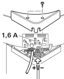
El fusible sensible debe sustituirse únicamente por un fusible equivalente. 1,6 A (lento), EN 60127-2-3.
