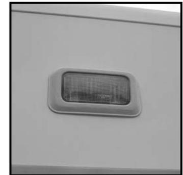
Un éclairage extérieur est fixé sur la paroi droite du véhicule. On peut l'allumer du tableau de contrôle, seulement quand le moteur est éteint.
