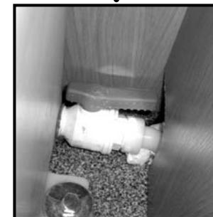
Robinet de vidange du réservoir de l'eau propre situé à l'intérieur, sous le lit postérieur sur modèle Ecovip R660 - R718.
