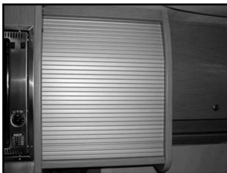
Porte-téléviseur monté sur tous les modèles Ecovip. À l'intérieur, il est muni d'une prise 12V et d'une prise TV.
