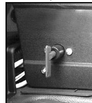
Interrupteur coupe-batterie monté sur tous les véhicules situé sur la base du siège de la cabine.
