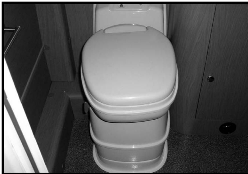
Sur certains véhicules de la gamme Ecovip, est prévu un WC à cassette. Ce système prévoit un réservoir autonome de 17 litres amovible au moyen d'un portillon situé à l'extérieur du véhicule. Avant l'utilisation, il faut préparer une solution composée d'un demi-litre d'eau et de 50cc de produit chimique spécial.
