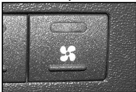
Sur châssis FIAT, le réchauffeur auxiliaire est "de série" avec le chauffage du châssis de base. Cela signifie que le réglage chaud/froid sur le tableau de bord comprend aussi bien le chauffage de la cabine que celui de la cellule d'habitation au moyen du réchauffeur. Le réchauffeur auxiliaire peut être actionné à l'aide du bouton indiqué en photo.
