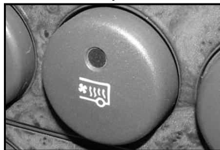
Sur le châssis IVECO, le réchauffeur est équipé d'une vanne de fermeture commandée par le bouton-poussoir (indiqué en photo): lorsque le réchauffeur est fermé, la vanne est fermée et la chaleur ne se répand pas dans l'habitacle; quand on allume le réchauffeur, la vanne aussi s'ouvre automatiquement pour le passage du liquide de l'installation.
