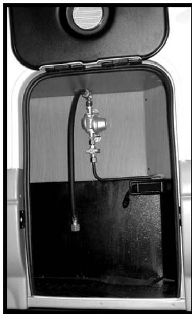
L'installation du gaz, taré sur une pression d'exercice de 30 mbar, part du coffre à bouteilles de gaz complètement étanche par rapport à la cellule et équipé de grilles d'aération vers l'extérieur.
