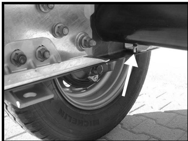
Sur la surface inférieure de l'essieu postérieur, placé en face des deux extrémités, il y a deux buses qui servent à graisser l'essieu.
