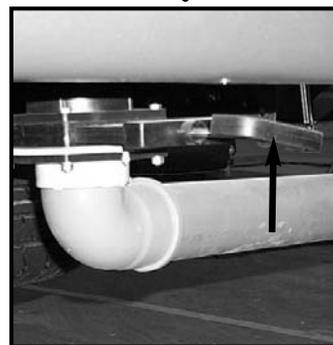
Poignée extérieure pour la vanne d'évacuation. La poignée est toujours déterminée par un autocollant "WC" placé sur le bas de caisse.
