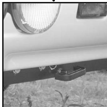
Poignée pour la vidange du réservoir des eaux usées positionnée en face des pare-chocs côté gauche sur les modèles Ecovip 8.1
