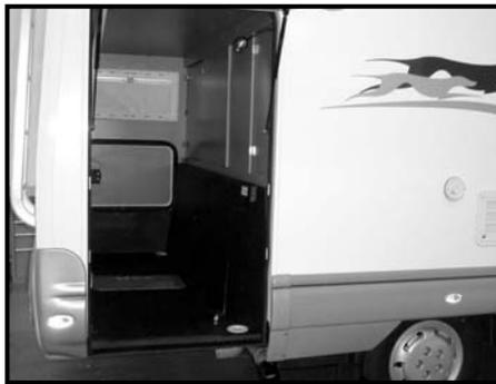
Garage: le poids du chargement complet dans le garage ne doit pas être supérieur à celui indiqué sur la plaque située dans le garage même.
