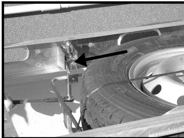
Pour le remplacement d'une roue arrière, il existe une plaque qui sert à fixer le vérin d'élévation. Veiller à ce que le vérin soit positionné en face de la plaque.
