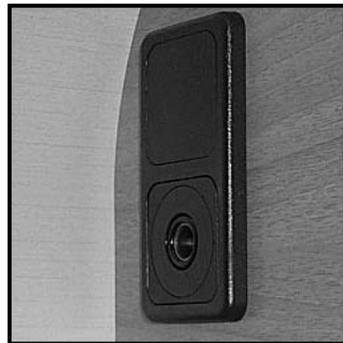
Une prise 12V est prévue sur chaque véhicule à l'intérieur du compartiment porte-téléviseur. Elle est alimentée directement par la batterie.
