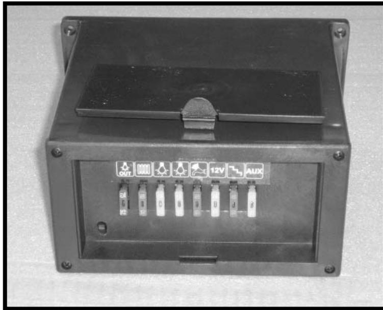
Sous le siège du conducteur on trouve la centrale de distribution services et l'alimentateur/chargeur de batterie.
