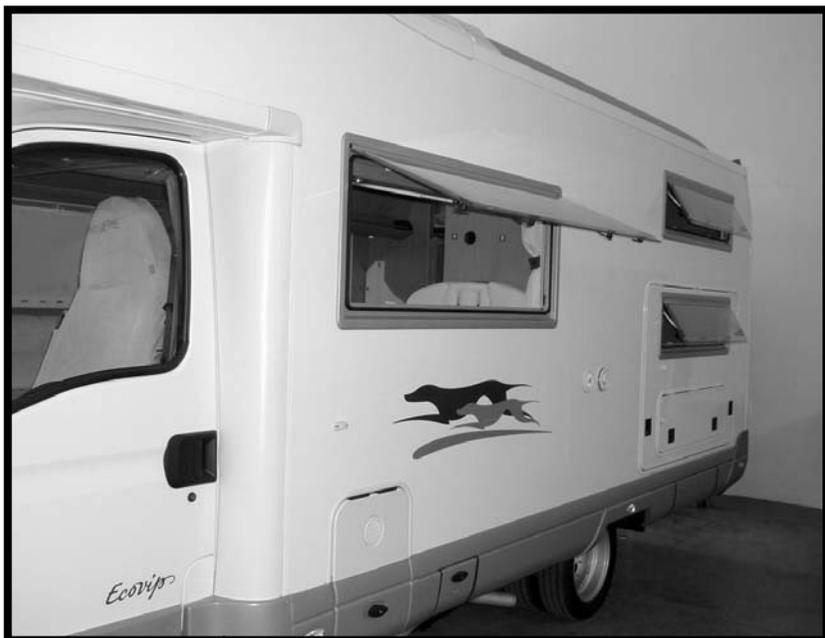
Les baies utilisées sont composées d'un encadrement extérieur, d'un encadrement intérieur et d'un double vitrage ouvrant qui peut être de type coulissant ou projetant.
