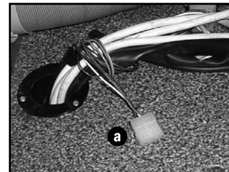
a) Prédisection existant sur les camping-cars et les profilés Ecovip: câblage pour la visualisation du niveau du réservoir supplémentaire. Il est déjà installé sur le groupe de puissance et arrive à l'Ecovip 2.1 tw - 9.1g dans la penderie; 4.1 dans le coffre du côté gauche; 2.1 classic - 8.1 - 10.1 dans le coffre du côté droit; R660 sous le lit à côté du chauffage; R718 sous le lit.
